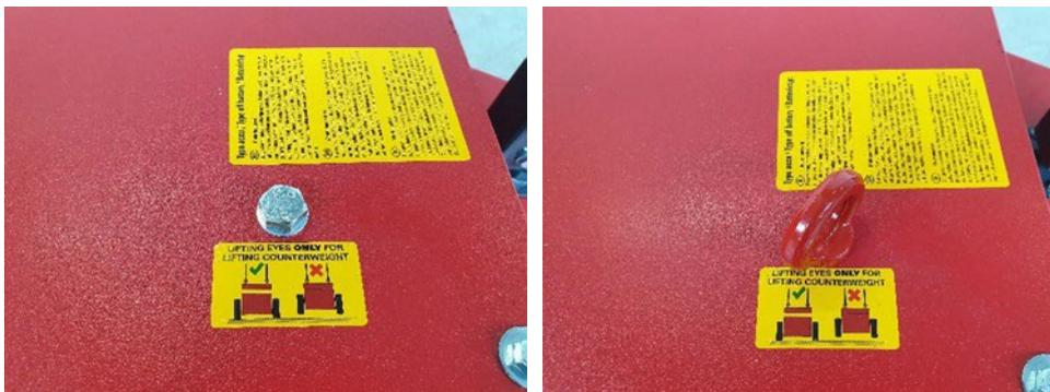
Este modelo puede tener capas de contrapeso de aprox. 600-900 kg cada uno. Puede levantarlos de la máquina con los 4 cáncamos suministrados. Atornille estos cáncamos de elevación en los orificios provistos. (ver foto). De esta manera, solo puede levantar el paquete de peso y no toda la máquina.
